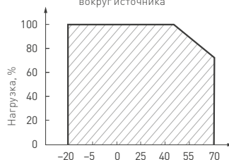
Рис. 4. Максимальная допустимая нагрузка, % от мощности источника
