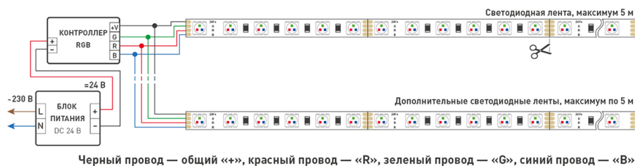
Схема 1. Подключение нескольких светодиодных лент с одной стороны.
