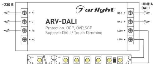
Рис. 1. Подключение источника напряжения.
