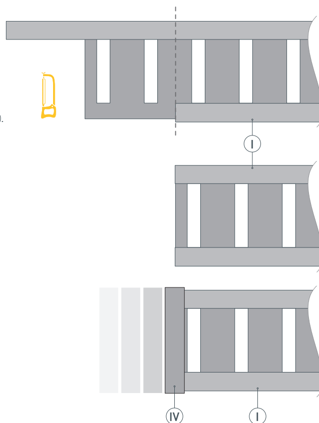
Рис. 4. Обрезка лишних частей профиля ① и установка заглушки. Вид сверху
